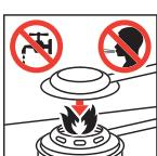
Flamme darf nur mit Löschkappe gelöscht werden. Nicht auspussten oder mit Wasser löschen!
