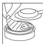
Packung mit Brennpaste in Brenner-Unterteil einlegen.
