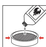
Deckfolie abreißen oder Sicherheitspaste einfüllen, max. bis Becherabsatz.
